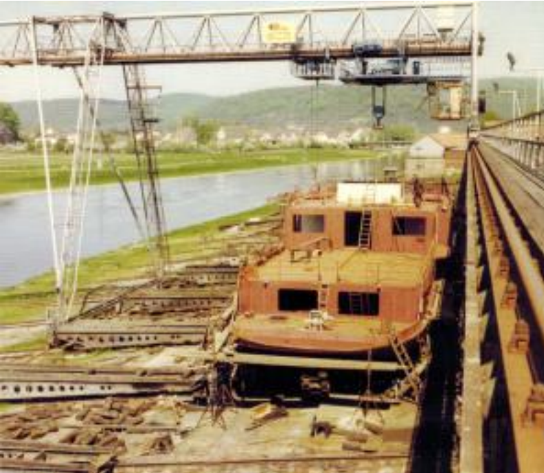
Das Personenmotorschiff "Holzminden" im Rohbau auf Hel- ling II. Ansonsten ist die gesamte Slipanlage ungenutzt.
